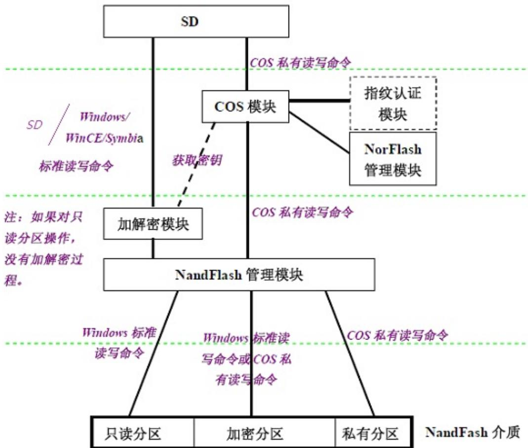
整个方案采用 SD 命令及 Mass storage Diver 作为驱动协议，这样在包括 Windows, WinCE, Linux, Symbian 等系统下都可以直接使用，不用安装额外的驱动。针对于各个不同智能卡厂商现有的 CSP、PKCS#11 甚至私有 API 库以及 COS，都不需要做复杂的改动，只需要按照专用的 firmware 协议变更一下函数接口，就可以实现命令的转换和传输，并立即拥有自己的安全移动产品。
